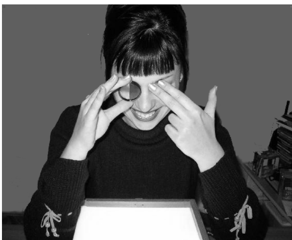
Рисунок 1. Формирование монокулярных Q-стимулов с использованием мозаичных светофильтров
